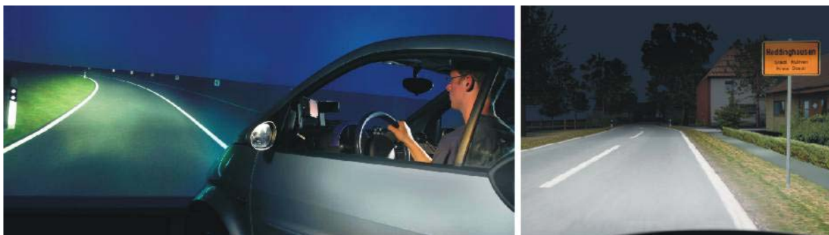
Abbildung 1: Nightdriver : Smart vor drei Projektionswänden (links), beleuchtete Szenerie im Nightdriver (rechts)
